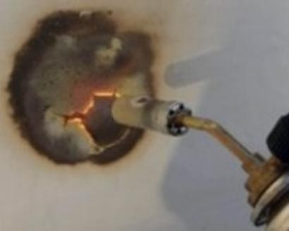
Теплометт не поддерживает горение, материал в пламени горелки обугливается без выделения токсичных веществ
